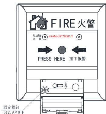
图 3 报警按钮安装图
