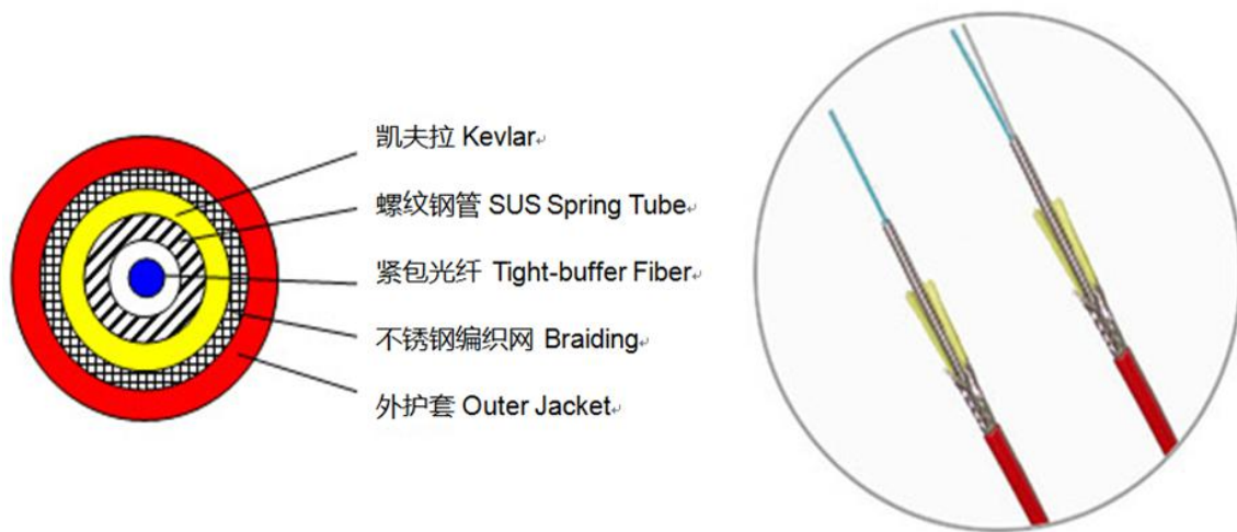
图 2-3： 感温光缆结构图示例
